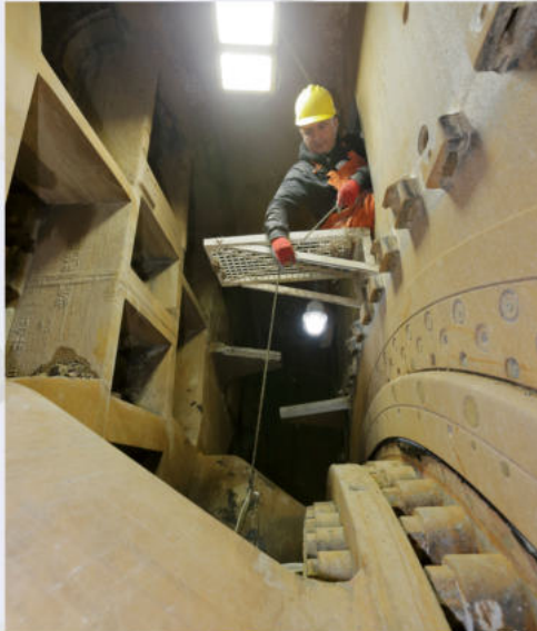
Εργασίες συντήρησης στον θάλαμο εκσκαφής - TBM «ΑΘΗΝΑ»
